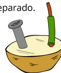
Con esto se tendrá una unidad de batería, que llamaremos celda, y ya se puede conectar con los alambres al foco LED o dispositivo que quisieras prender, cada metal va a uno de los puntos de conexión del dispositivo (a). Puedes utilizar más celdas, que se deben conectar entre ellas, del clavo al pedazo de cobre, y así sucesivamente hasta que tengas las celdas que quieras, o las necesarias para prender el dispositivo (b).
